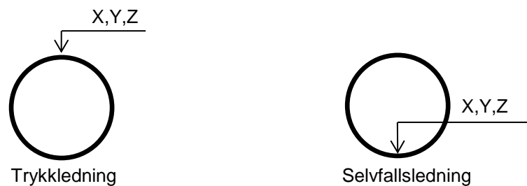
Figur 1. Måling av ledningshøyde.
