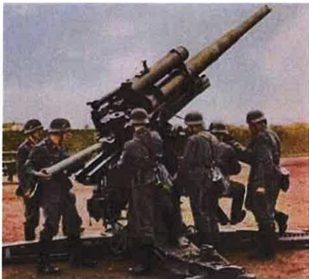
Flak 88 mm: vekt 7,5 tonn; lengde 5,8 m; høyde 2,1
